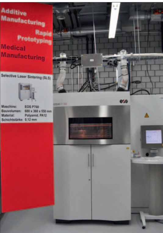
Bild 3: Die EOS P 760 ist die erste Doppelkopfanlage zum Lasersintern von Kunststoffen.
