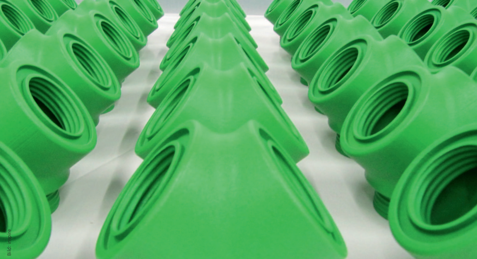
AM-Bauteile gefertigt bei Inspire, irpd mit SLS (Selective Laser Sintering).
