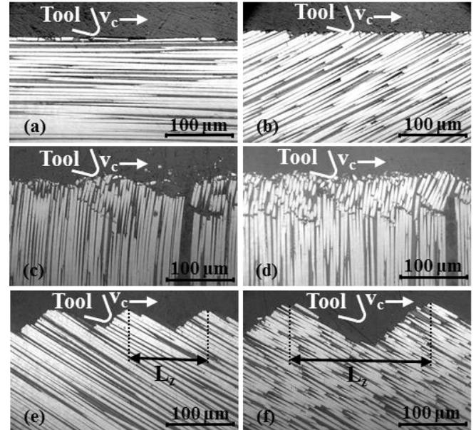
Fig. 8. Micrographs of CFRP surface: (a)  $\theta=0^\circ$  H( $10^\circ, 14^\circ$ ); (b)  $\theta=30^\circ$  H( $10^\circ, 14^\circ$ ); (c)  $\theta=90^\circ$  J( $20^\circ, 7^\circ$ ); (d)  $\theta=90^\circ$  M( $20^\circ, 21^\circ$ ); (e)  $\theta=150^\circ$  C( $0^\circ, 14^\circ$ ); (f)  $\theta=150^\circ$  L( $20^\circ, 14^\circ$ ).
